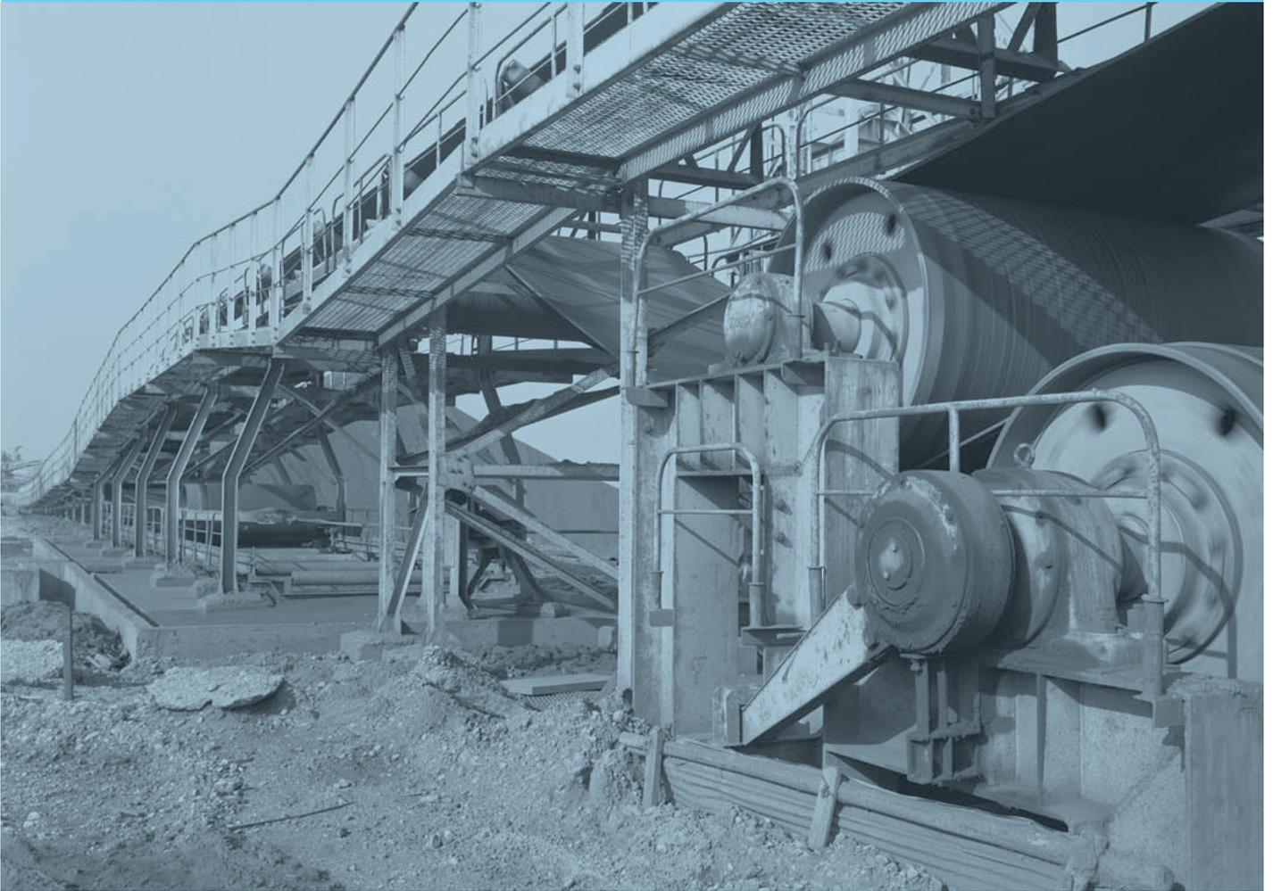
Koyo プランマブロックは、重荷重、衝撃荷重の多い製鉄所各設備に数多く使用され、合理化や省力化に役立っている。
