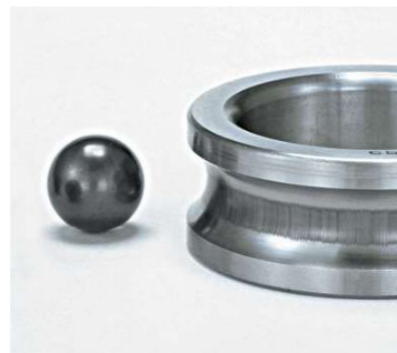
图 4-3 普通轴承上发生的电蚀(脊形标记)
