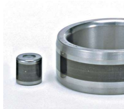
图 4-2 普通轴承上发生的电蚀(坑)
