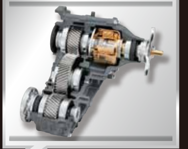
センターデフ搭載例 Center differential installation
