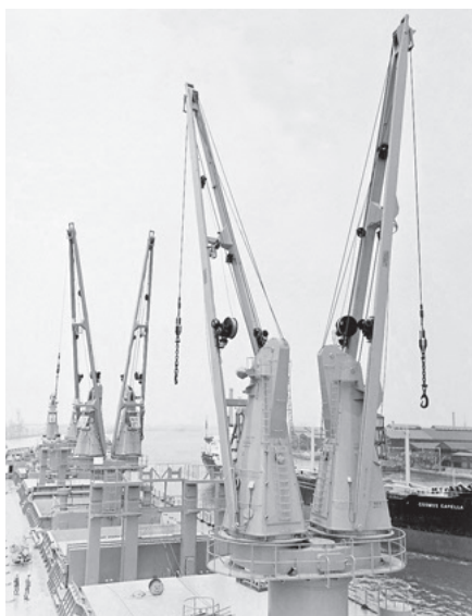
デッキクレーン
