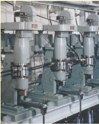
図 1-3 転がり疲れ寿命試験の条件と装置
