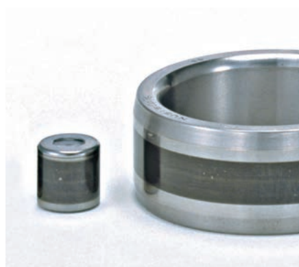
図 4-2 一般軸受到に生じた電食（ピット）
