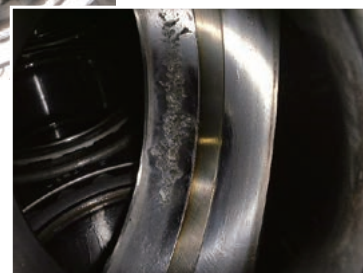
二山摩耗が起点となった外輪の割損と外輪軌道面の剥離
