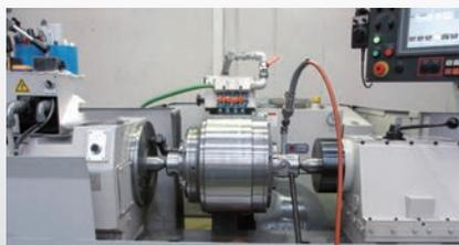
軸受と治具を研削盤に取付けた状態
