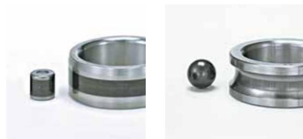
図17 一般軸受に生じた電食(ピット)
