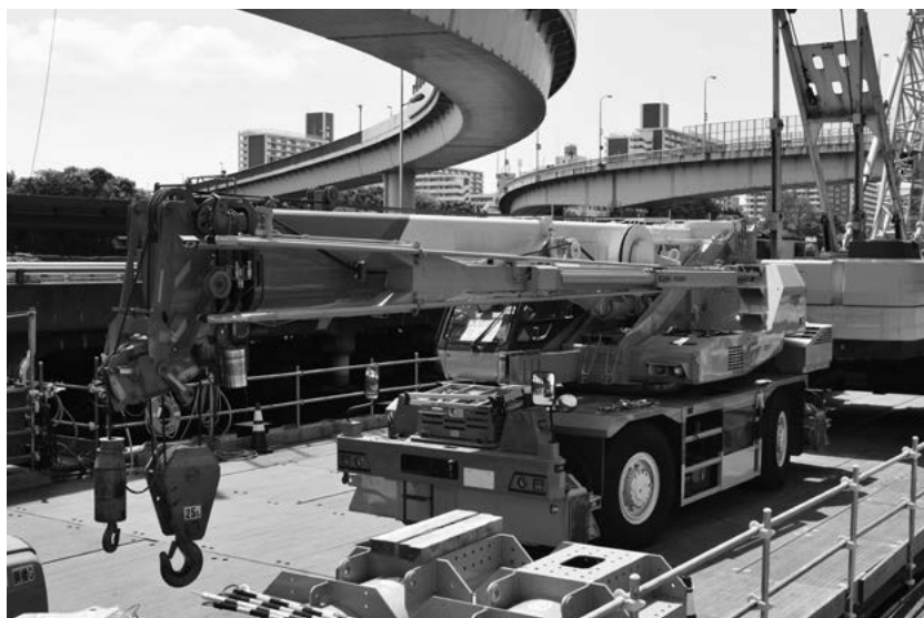
トラッククレーン
