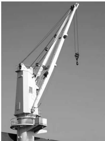
デッキクレーン
