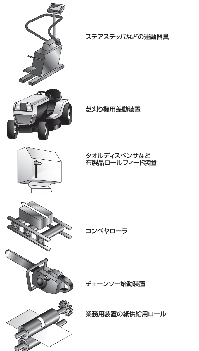
図B3-9(1) シェル形クラッチと軸受内蔵クラッチの使用例
