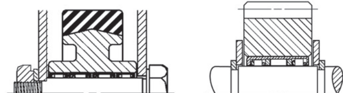
図B3-7 重荷重時のクラッチと軸受の配置
