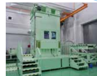
鉄鋼製造設備用軸受試験機
